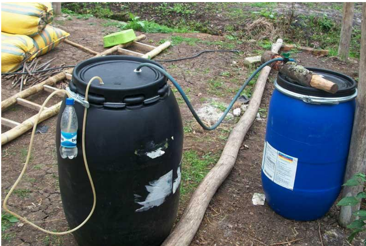
EL SISTEMA MONTADO. NÓTESE LA BOTELLITA COLGADA EN EL BIDÓN DE LA IZQUIERDA, POR DONDE SE EVACÚAN LOS GASES.
